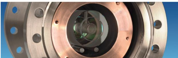
Optische Atomuhren basieren entweder auf der Spektroskopie einzelner Ionen in einer Hochfrequenzfalle (oben), oder tausender neutraler Atome, die in einer optischen Falle gehalten werden (Mitte, Pfeil zeigt auf Atomwolke). Der Oszillator der optischen Uhr ist ein Laser, dessen Frequenz mit einem optischen Resonator\* (unten, Blick in die Vakuumkammer), auf kurzen Zeitskalen vorstabilisiert wird.
